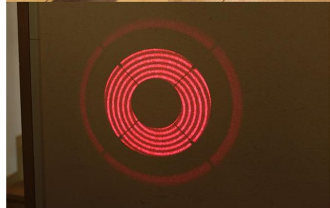
Le laser simple ne permet pas de collimater les formules SC et RC, cette limitation est résolue par un laser très particulier, l'Howie Glatter's qui génère des anneaux de lumière. Le principe (qu'on n'expliquera pas en détail ici), consiste à rendre ces anneaux concentriques avec leur reflet sur primaire. Ça peut être très précis car un des anneaux peut être superposé exactement sur le pourtour du miroir.
