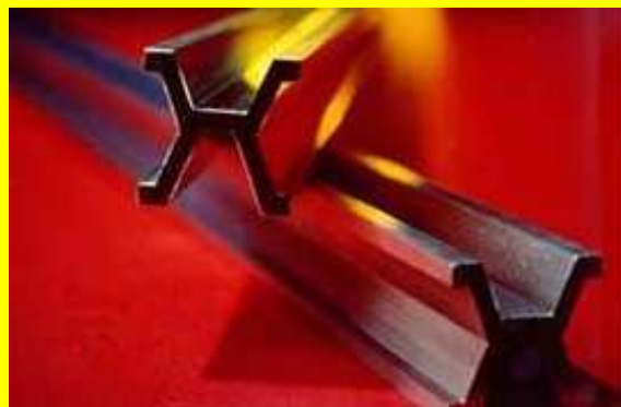
Barre de platine - iridium utilisé comme prototype du mètre de 1889 à 1960.
