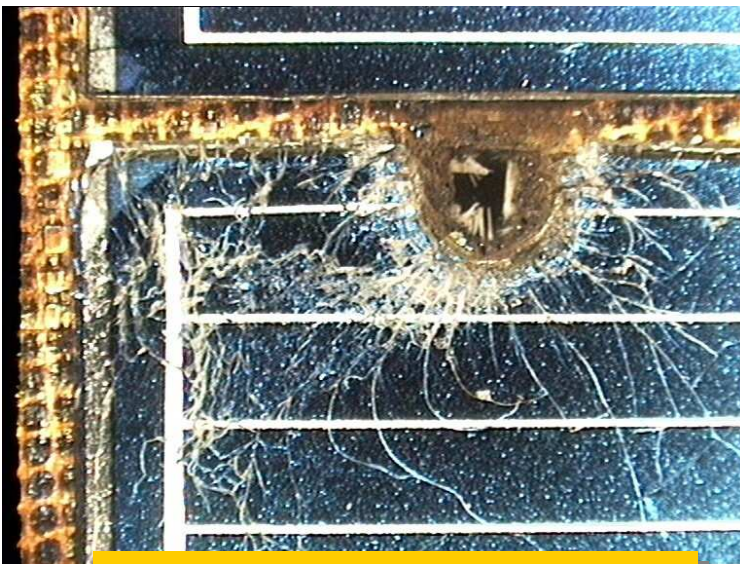
Impact sur un panneau solaire du télescope Hubble
